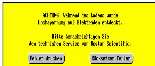
**Abbildung 2. Warnmeldung, die anzeigt, dass bei zwei aufeinander folgenden Ladezyklen mehr als 8 Volt an den Elektroden gemessen wurden.**
